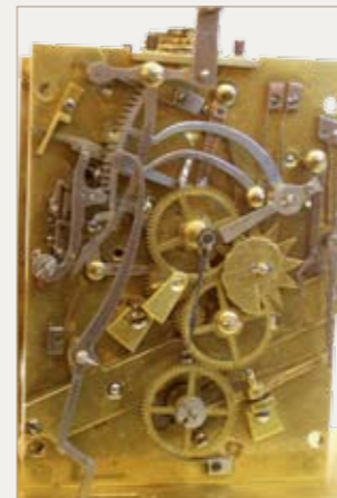
Швейцария кон. XIX в. Paul Buhre. Сложный и удивительный механизм боя каретных часов
