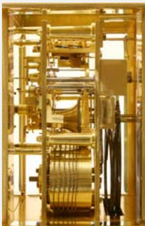
Англия, кон. XIX в. Часовой механизм сложных каретных часов с фюзеей. Средняя стоимость старинных каретных часов с таким устройством составляет от $20 000
