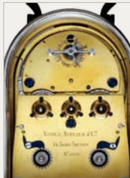
Лондон, 1905. Механизм сложных английских каретных часов Nicole Nielsen & Co с фюзеей, турбийоном и большим боем
