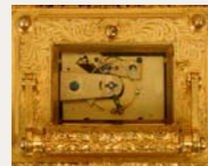
Англия, кон. XIX в. Приставной регулятор каретных часов с редким хронометровым ходом (вид сверху)
